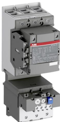
Прямой пуск является самым простым, экономичным, компактным и наиболее распространенным способом пуска электродвигателей. В связи с высоким пусковым током и крутящим моментом при пуске его можно использовать только в стабильных электрических сетях и с нагрузкой, имеющей жесткое соединение всех приводных элементов.
