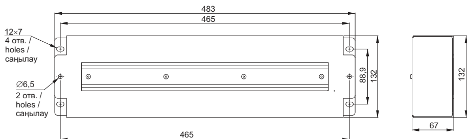
Рисунок – Габаритные и установочные размеры панели / Figure 1 – Overall and mounting dimensions of the panel /
