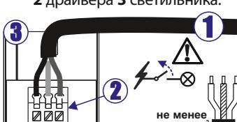
Подключите питающий провод 1 к проводу светильника 2.
