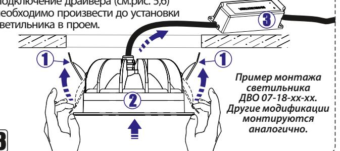
Пример монтажа светильника DVO 07-18-хх-хх. Другие модификации монтируются аналогично.
