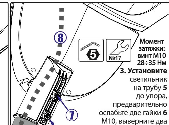
4. Зафиксируйте светильник в рабочем положении, затяните два винта 7 M10, две гайки 6 M10;
