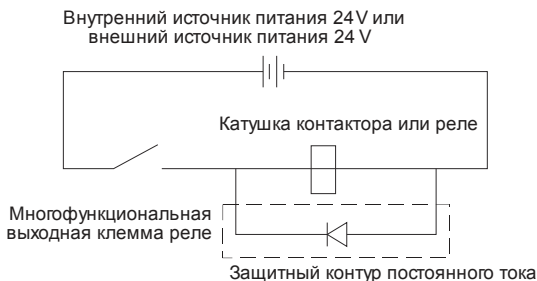
Рисунок 18 — Схема подключения выходного реле на постоянный ток
