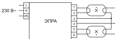
Рисунок 4. Электрическая схема подключения ЭПРА 218, ЭПРА 236, ЭПРА 226, ЭПРА 218М, ЭПРА 236М, ЭПРА 258М
