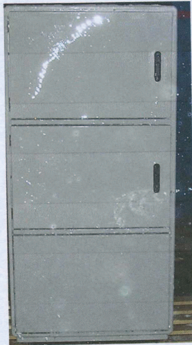
Рис. 5 Корпус шкафа из фиброгласа «Conchiglia» в процессе обрызгивания оболочки со всех сторон водой.
