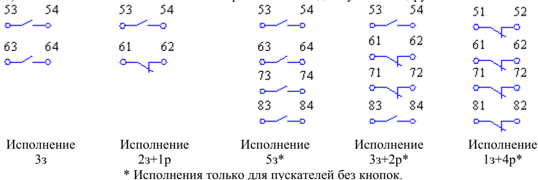
Рис. 2.17 - Пускатели неперевосимые типа ПМ12-025, ПМ12-040 без реле в оболочках степени защиты IP40, IP54
