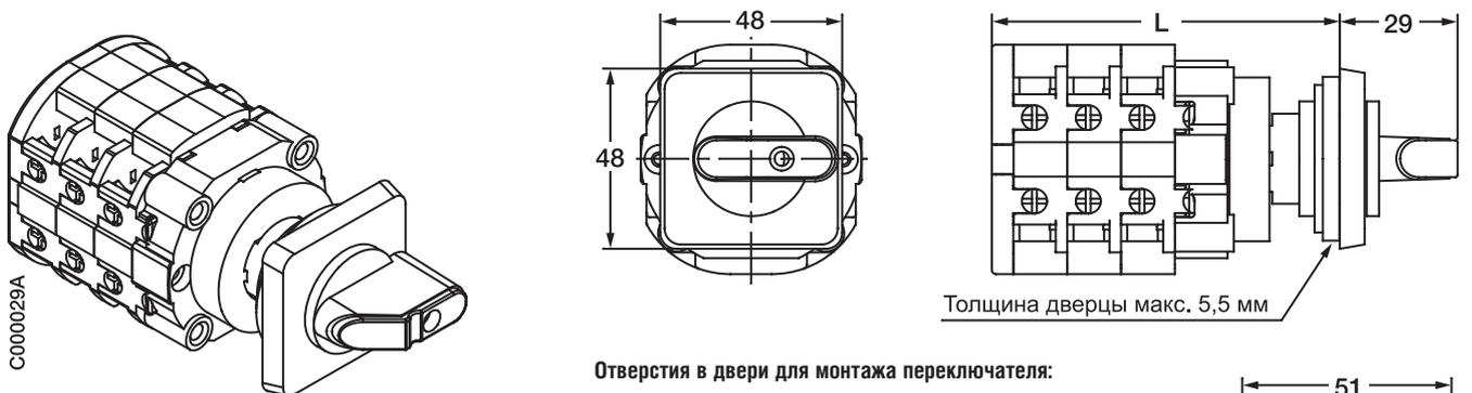
Отверстия в двери для монтажа переключателя:
