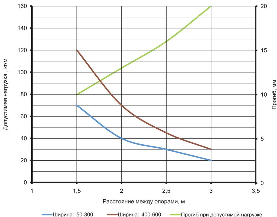
**Условия испытаний лотков на безопасную рабочую нагрузку:**
