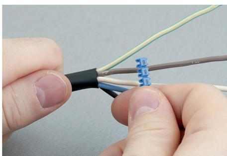
Возьмите ленту с необходимыми символами и закрепите крайний тег на маркируемой поверхности
