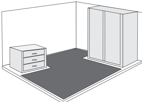
3) Под полученную полезную площадь подберите нагревательный мат, площадь которого примерно равна или меньше площади обогрева. Внимание! Площадь нагревательного мата не может превышать полезную площадь обогрева.
