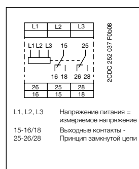
Схема подключения CM-PAS.x1
