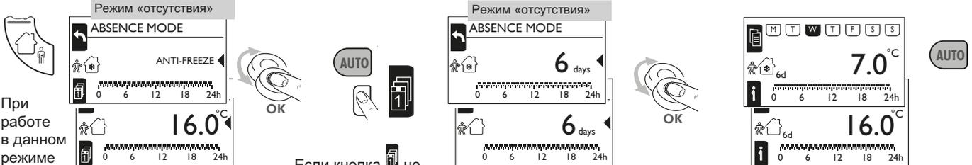
При работе в данном режиме можно включить один из двух температурных уровня: экономичный или защиты от замерзания с 00 до 24 часов. Данный режим может быть включен на неограниченный период времени или на срок от 1 до 30 дней.
