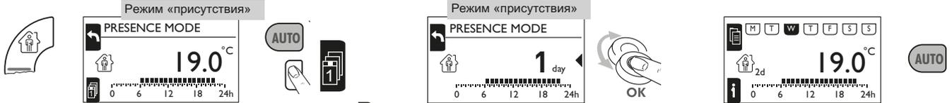
При работе в данном режиме температура комфорта включается с 6:00-22:00/0:00-24:00 часов, в остальное время отопление работает в режиме экономии. Данный режим может быть включен на неограниченный период времени или на срок от 1 до 30 дней.
