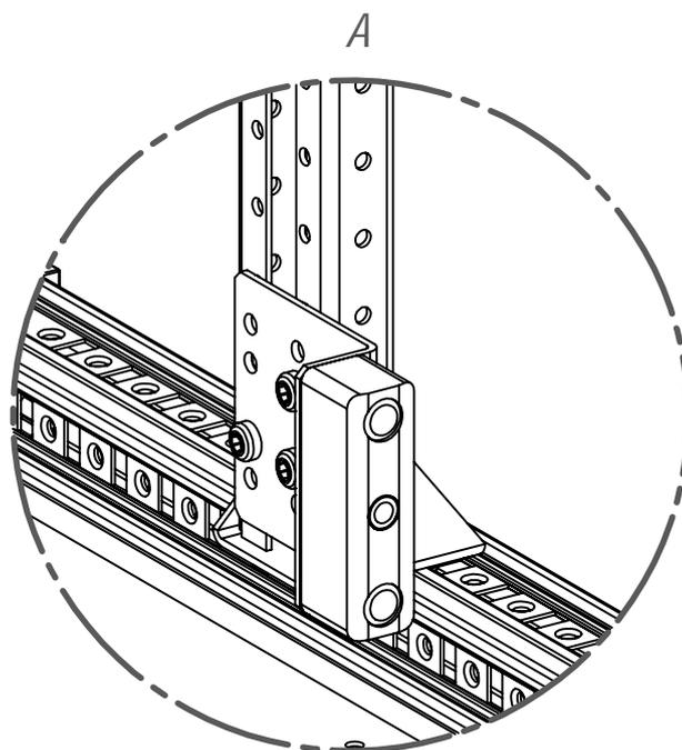
Высота установки кронштейнов комплекта RUBKN0002 определяется индивидуально. Шаг установки 12,5мм.
