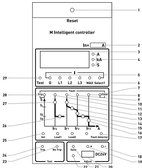
1. Кнопка-индикатор автоматического срабатывания от сверхтока и разрешения на включение автоматического выключателя.
