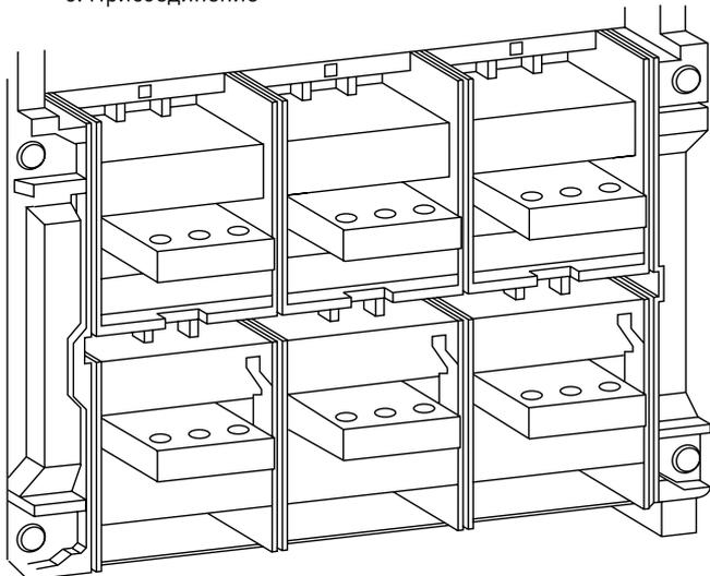
Выводы выключателя расположены сзади, шины при подключении к выключателю должны располагаться горизонтально.
