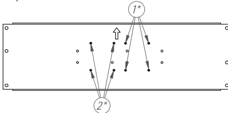
1\*- места крепления аппарата, при подключении к сборным шинам справа.
