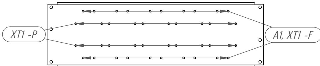
Крепление аппаратов TmaxXT1-P осуществляется с использованием втулок, высотой 20мм. (входят в комплект поставки фиксированных частей аппаратов).
