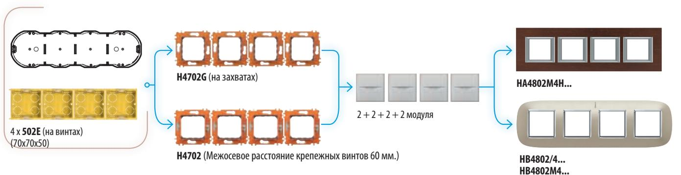
**ПРИМЕЧАНИЕ:** суппорты поставляются с защитными рамкой и крышкой. Рекомендуется использовать защитные крышки в течение всего времени проведения монтажных работ и устанавливать декоративные накладки только после их завершения.
