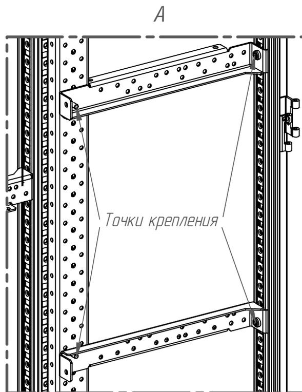
Высота установки и размер модуля RUBKM0004 определяется индивидуально.
