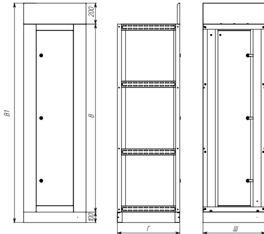
Рис.1 - Общий вид шкафов ЩО-70 Unit
