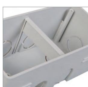
В комплект лючка серии mini В входит распорка, которая применяется при установке корпуса в стену и исключает его деформацию при заливке бетоном.
