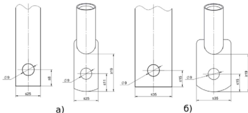
**Рисунок 5** - Форма и размеры присоединяемой шины максимального сечения
