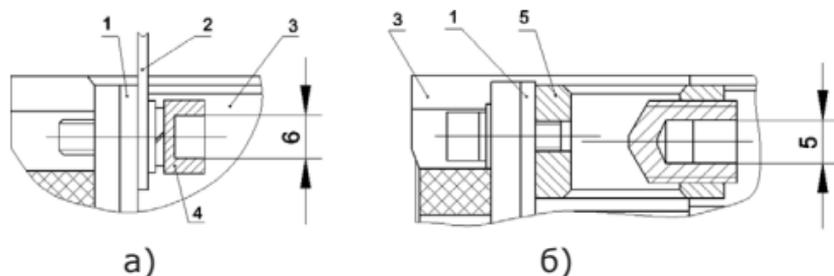
а) присоединение шинами или жилами кабеля с кабельным наконечником,
