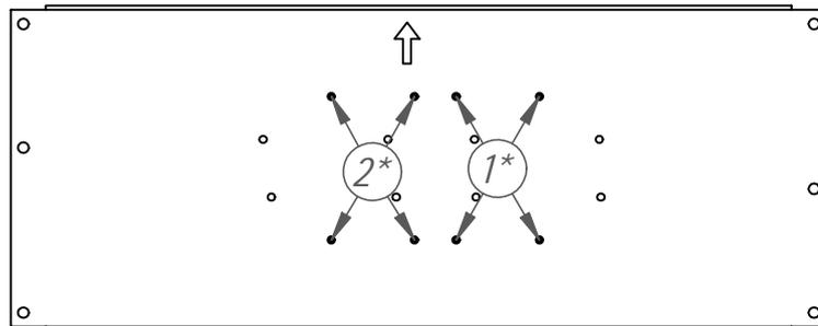
1\*- места крепления аппарата, при подключении к сборным шинам справа.
