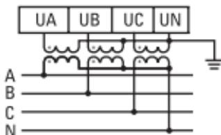
Рис.5 Схема подключения вольтметра через трансформатор напряжения
