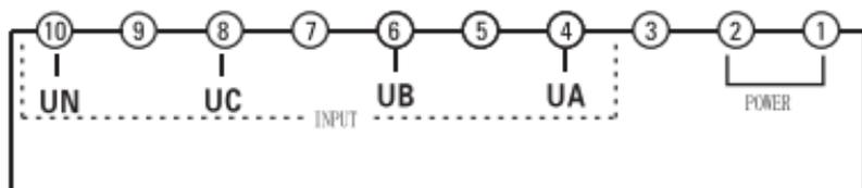
Рис. 6 Обозначение клемм для приборов размером 96x96
