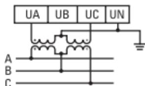
Рис.4 Схема подключения вольтметра через трансформатор напряжения
