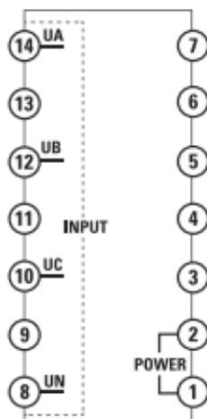
Рис. 7 Обозначение клемм для приборов размером 72x72
