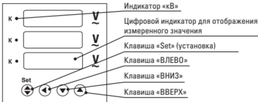
Рис.1 Лицевая панель прибора
