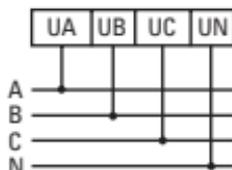
Рис.3 Схема непосредственного подключения вольтметра при  $U \leq 500\text{В}$
