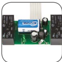
Два встроенных реле на токи до 16 А
