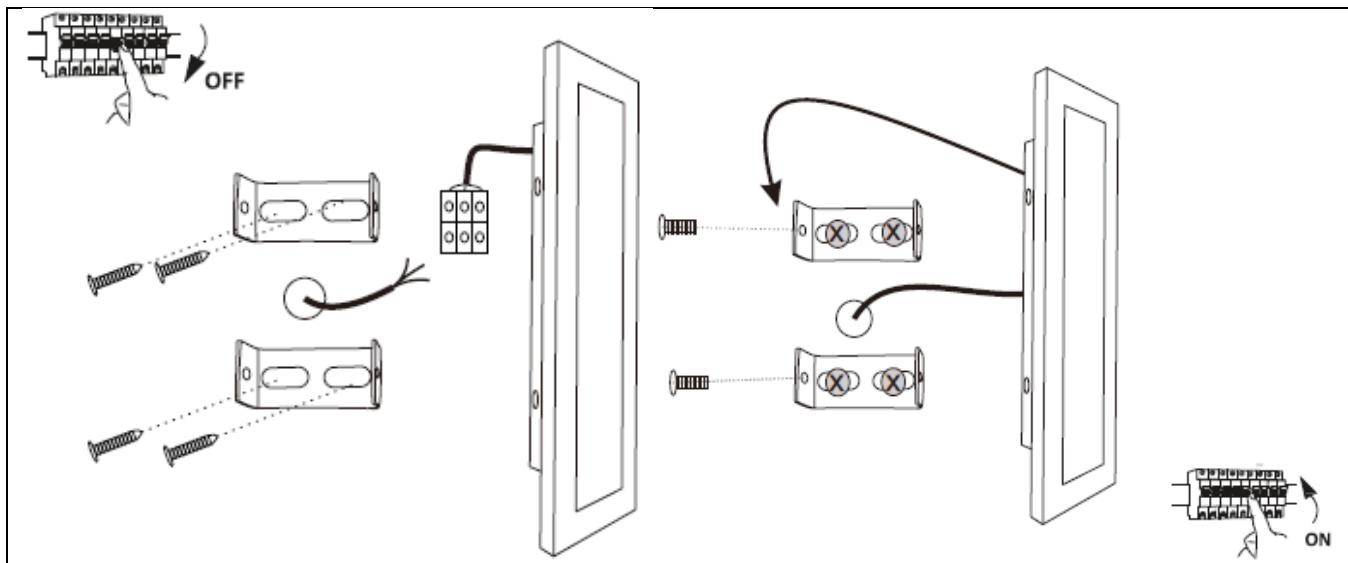
1. Разметьте монтажную поверхность, просверлите в монтажной поверхности необходимые отверстия и вставьте в отверстия пластиковые дюбели. Затем закрепите крепежные скобы светильника на монтажной поверхности при помощи саморезов.
