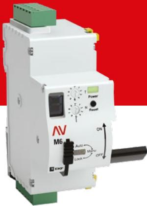
AV-M6 EKF AVERES – моторный привод с возможностью управления по команде и работой в автоматическом режиме. В настройках автоматического режима реклоузера регулируется количество взведений и время, через которое они будут происходить. В случае неустраненного КЗ моторный привод не производит повторное включение. Устройство имеет также режим блокировки для проведения ремонтных работ на линии. Возможна коммутация алюминиевым и медным проводом.
