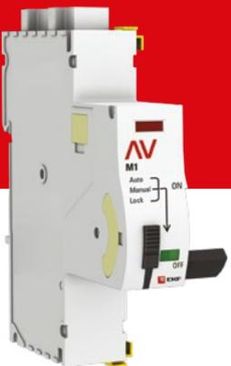
AV-M1 EKF AVERES – моторный привод с возможностью управления как по команде, так и работой в автоматическом режиме. Устройство имеет также режим блокировки для проведения ремонтных работ на линии. AV-M1 EKF AVERES имеет возможность подключения только к одно- и двухполюсным автоматам AV-6 и AV-10 EKF AVERES.
