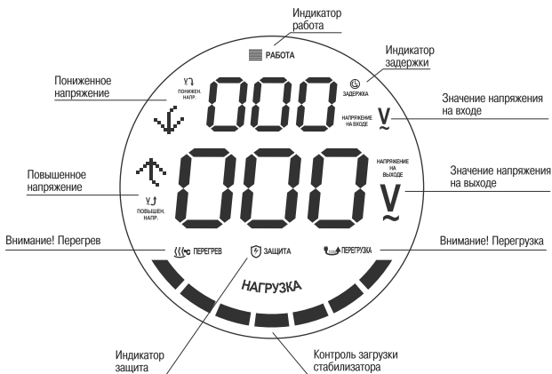
Рис 3. Индикация режимов работы переносных стабилизаторов
