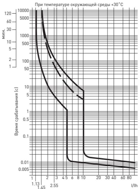
Изменение характеристики расцепления выключателей зависит от двух основных факторов - количества параллельно размещенных (рядом друг с другом) выключателей и температуры окружающего воздуха. При расчете тока неотключения для параллельно размещенных выключателей в зависимости от их количества (N) и температуры окружающего воздуха ( $t$  °C) вводятся поправочные коэффициенты:
