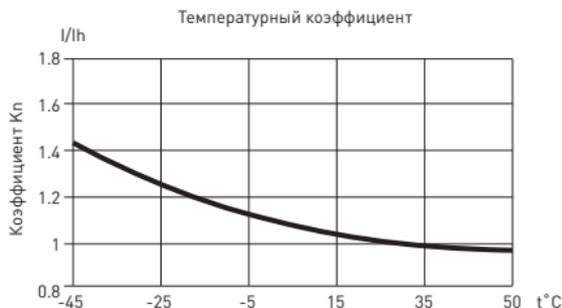
Ток неотключения для параллельно размещенных выключателей в зависимости от их количества и температуры окружающего воздуха определяется по формуле:
