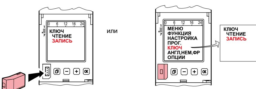
Загрузите программы из программного ключа в таймер (операция ЗАПИСЬ КЛЮЧ)
