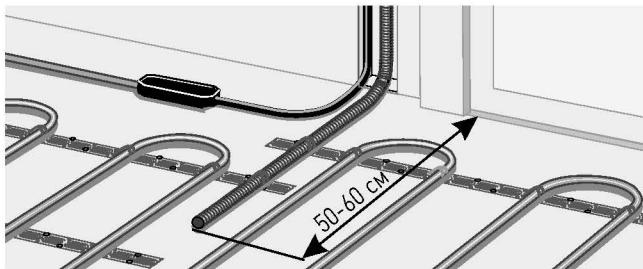
5. После закрепления гофрированной трубы на полу и на стене необходимо убедиться в том, что датчик свободно перемещается внутри трубы. Для этого достаточно частично вытянуть и затем обратно вставить соединительный провод датчика. Такой способ монтажа применяется, чтобы можно было при необходимости легко заменить датчик.
