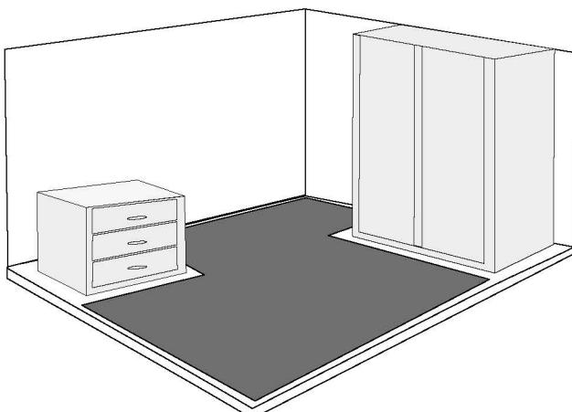
3. Под полученную полезную площадь подберите нагревательный мат, площадь которого примерно равна или меньше площади обогрева.
