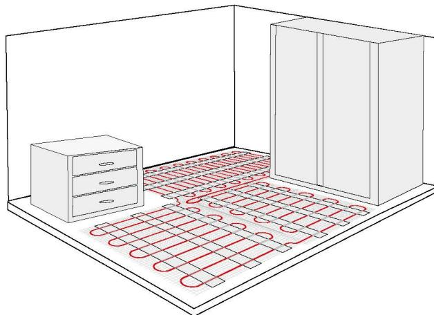
4. Измерьте сопротивление мата перед раскладкой. Полученное значение должно соответствовать данным, указанным в таблице ассортимента. Чтобы разложить мат по форме обогреваемой площади, необходимо разрезать его на фрагменты, при этом не затрагивая нагревательный кабель. Не допускается наложение фрагментов друг на друга.
